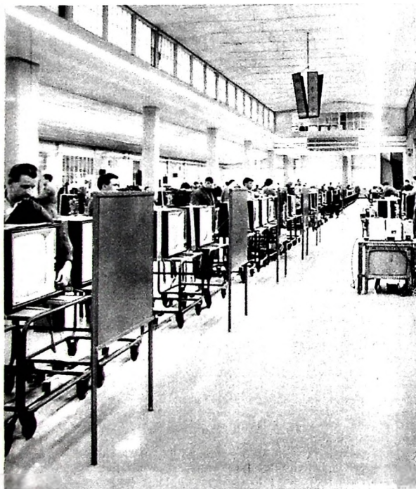
Blick in die Fernsehempfänger-Endmontage-Halle. Im Vordergrund die Einstellplätze für die Bildgeometrie
