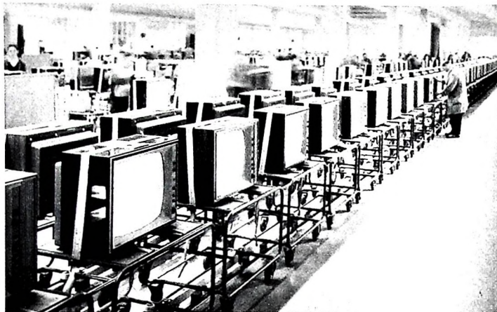
Das 65 m lange Dauerprüfband, das jeder Grundig-Fernsempfänger durchlaufen muß, bevor er zur Endkontrolle gelangt
